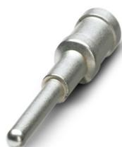
Contatto a crimpare, Serie di prodotti: PRC 35, sezione del conduttore max.: 2,5 mm<sup>2</sup>, tensione di dimensionamento: 690 V AC, corrente nominale: 24 A, Tipo di connessione: Connessione a crimpare, Tipo di connessione del contatto: Spina, Raccomandazioni per la crimpatura: crimpare i conduttori conformemente alla norma DIN EN 60352-2 con il contatto a crimpare.
