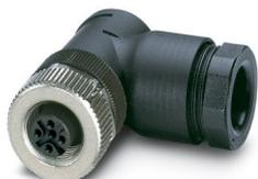
Connettore Power, 4-poli, Femmina angolato M12, codifica: A, Connessione a vite, materiale zigrinato: Pressogetto di zinco, nichelato, connessione a vite per cavo Pg11, diametro esterno conduttore 8 mm ... 10 mm
