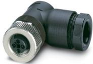
Connettore Power, 4-poli, non schermata, Femmina angolato M12, codifica: T, Connessione a vite, materiale zigrinato: Pressogetto di zinco, nichelato, connessione a vite per cavo Pg11, diametro esterno conduttore 8 mm ... 10 mm, per corrente continua fino a 12 A / 63 V
