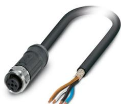
Cavo sensore/attuatore, 4-poli, PE-X/PE-X senza alogenati, grigio-nero RAL 7021, schermata, estremità conduttore libera, su Connettore femmina diritto M12, codifica: A, lunghezza cavo: 30 m, per applicazioni outdoor, con zigrinatura in acciaio inox
