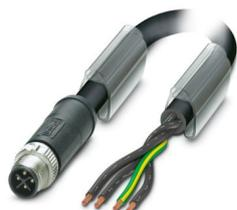
Cavo di alimentazione, 4-poli, PUR senza alogenati, grigio-nero RAL 7021, Maschio diritto M12, codifica: S, su estremità conduttore libera, lunghezza cavo: 1 m, per corrente alternata fino a 12 A/690 V
