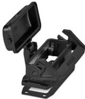
Custodia da incasso B16, con blocc. longitudinale, materiale: PA 6.6-FR, materiale coperchio: PC, altezza: 30,5 mm, connessione a vite per cavo: senza, coperchio di protezione: sì, Standard, con guarnizione piatta
