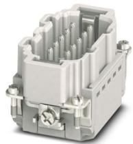
Inserto contatti, numero poli: 10+PE, dimensioni: B10, numero di connessioni per polo: 1, Spina, Connessione Push-in, 500 V, 16 A, 0,14 mm<sup>2</sup> ... 2,5 mm<sup>2</sup>, applicazione: Potenza
