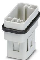
Inserto contatti, numero poli: 8+PE, dimensioni: COM, contatti di potenza: 8, contatti di comando: 0, numero di connessioni per polo: 1, Spina, Connessione a crimpare, 500 V, 16 A, 0,5 mm<sup>2</sup> ... 4 mm<sup>2</sup>, applicazione: Potenza, solo per custodie in plastica
