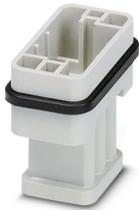
Inserto contatti, numero poli: 17+PE, dimensioni: COM, contatti di potenza: 0, contatti di comando: 17, numero di connessioni per polo: 1, Spina, Connessione a crimpare, 200 V, 10 A, 0,14 mm<sup>2</sup> ... 2,5 mm<sup>2</sup>, applicazione: Potenza, solo per custodie in plastica
