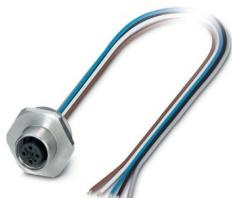
Connettore per apparecchi anteriore, Universale, 4-poli, Femmina, diritto, M12-Standard, codifica: A, su estremità conduttore libera, Montaggio anteriore, M20 x 1,5, Fili singoli, lunghezza cavo: 0,5 m, 0,34 mm<sup>2</sup>, Filo in TPE, saldato, Prodotto alternativo secondo RoHS II senza eccezione 6c (Pb < 0,1 %) cod. art.: 1238771
