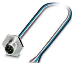
Connettore per apparecchi anteriore, Universale, 4-poli, Connettore, diritto, M12-Standard, codifica: A, su estremità conduttore libera, Montaggio anteriore, M20 x 1,5, Fili singoli, lunghezza cavo: 0,5 m, 0,34 mm<sup>2</sup>, Filo in TPE, saldato
