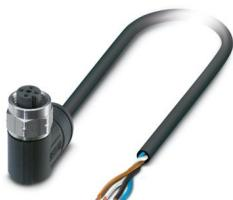
Cavo sensore/attuatore, 4-poli, PE-X senza alogenati, grigio-nero RAL 7021, estremità conduttore libera, su Connettore femmina angolato M12, codifica: A, lunghezza cavo: 10 m, per applicazioni outdoor , con zigrinatura in acciaio inox
