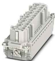
Inserto contatti, numero poli: 24+PE, dimensioni: B24, Femmina, Connessione Push-in, 500 V, 16 A, 0,14 mm<sup>2</sup> ... 2,5 mm<sup>2</sup>, applicazione: Potenza
