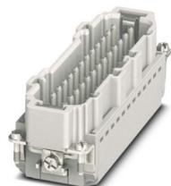
Inserto contatti, numero poli: 24+PE, dimensioni: B24, numero di connessioni per polo: 1, Spina, Connessione Push-in, 500 V, 16 A, 0,14 mm<sup>2</sup> ... 2,5 mm<sup>2</sup>, applicazione: Potenza
