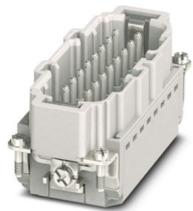
Inserto contatti, numero poli: 16+PE, dimensioni: B16, numero di connessioni per polo: 1, Spina, Connessione Push-in, 500 V, 16 A, 0,14 mm<sup>2</sup> ... 2,5 mm<sup>2</sup>, applicazione: Potenza
