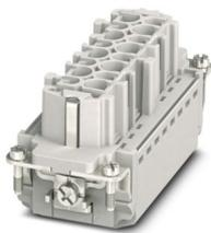
Inserto contatti, numero poli: 16+PE, dimensioni: B16, numero di connessioni per polo: 1, Femmina, Connessione Push-in, 500 V, 16 A, 0,14 mm<sup>2</sup> ... 2,5 mm<sup>2</sup>, applicazione: Potenza
