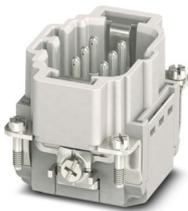
Inserto contatti, numero poli: 6+PE, dimensioni: B6, numero di connessioni per polo: 1, Spina, Connessione Push-in, 500 V, 16 A, 0,14 mm<sup>2</sup> ... 2,5 mm<sup>2</sup>, applicazione: Potenza
