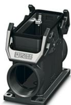
Custodia a zoccolo B16, con blocc. trasversale, materiale: PA 6.6-FR, uscite cavi: 2, laterali, 2x M40, altezza: 84 mm, connessione a vite per cavo: senza, Standard
