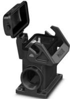
Custodia a zoccolo B10, con blocc. longitudinale, materiale: PA 6.6-FR, materiale coperchio: PC, uscite cavi: 2, laterali, 2x M32, altezza: 74 mm, connessione a vite per cavo: senza, coperchio di protezione: sì, Standard
