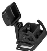
Custodia da incasso B6, con blocc. longitudinale, materiale: PA 6.6-FR, materiale coperchio: PC, altezza: 30,5 mm, connessione a vite per cavo: senza, coperchio di protezione: sì, Standard, con guarnizione piatta
