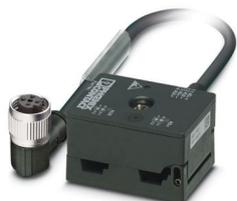
Distributore AS-Interface con grado di protezione elevato, per una diramazione di due cavi piatti su cavo a sezione circolare PUR da 2,0 m con connettore femmina angolato M12 SPEEDCON
