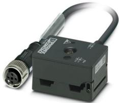
Distributore AS-Interface con grado di protezione elevato, per una diramazione di un cavo piatto su cavo a sezione circolare PUR da 2,0 m con connettore femmina diritto M12 SPEEDCON
