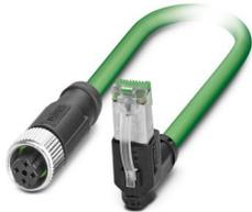
Cavo di rete, PROFINET CAT5 (100 MBit/s), EtherCAT® CAT5 (100 MBit/s), 4-poli, PVC/PVC, verde RAL 6018, schermata (Advanced Shielding Technology), Connettore femmina diritto M12, codifica: D / IP67, su Maschio angolato RJ45 / IP20, lunghezza cavo: 2 m
