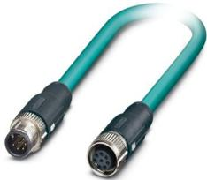
Cavo di rete, Ethernet CAT5 (1 Gbit/s), 8-poli, PUR senza alogenati, azzurro mare RAL 5021, schermata, Maschio diritto M12 SPEEDCON, codifica: A / IP67, su Connettore femmina diritto M12 SPEEDCON, codifica: A / IP67, lunghezza cavo: 5 m
