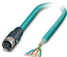
Cavo di rete, Ethernet CAT5 (1 Gbit/s), 8-poli, PUR senza alogenati, azzurro mare RAL 5021, schermata, estremità conduttore libera, su Connettore femmina diritto M12 SPEEDCON, codifica: A / IP67, lunghezza cavo: 2 m
