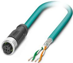
Cavo di rete, Ethernet CAT5 (100 MBit/s), 4-poli, PUR senza alogenati, azzurro mare RAL 5021, schermata (Advanced Shielding Technology), estremità conduttore libera, su Connettore femmina diritto M12, codifica: D / IP67, lunghezza cavo: 1 m
