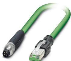
Cavo di rete, Ethernet (100 MBit/s), PROFINET (100 MBit/s), EtherCAT® (100 MBit/s), 4-pol, PVC/PVC, verde RAL 6018, schermata, Maschio diritto M8, codifica: A / IP67, su Maschio diritto RJ45 / IP20, lunghezza cavo: 10 m
