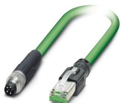
Cavo di rete, Ethernet (100 MBit/s), PROFINET (100 MBit/s), EtherCAT® (100 MBit/s), 4-pol., PVC/PVC, verde RAL 6018, schermata, Maschio diritto M8, codifica: A / IP67, su Maschio diritto RJ45 / IP20, lunghezza cavo: 2 m
