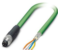
Cavo di rete, Ethernet (100 MBit/s), PROFINET (100 MBit/s), EtherCAT® (100 MBit/s), 4-poli, PVC/PVC, verde RAL 6018, schermata, Maschio diritto M8, codifica: A / IP67, su estremità conduttore libera, lunghezza cavo: 2 m
