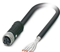
Cavo sensore/attuatore, 5-poli, PE-X senza alogenati, nero, schermata, estremità conduttore libera, su Connettore femmina diritto M12 SPEEDCON, codifica: A, lunghezza cavo: 5 m, Per le applicazioni ferroviarie
