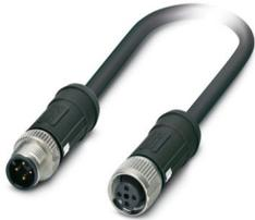
Cavo sensore/attuatore, 4-poli, PE-X senza alogenati, nero RAL 9005, schermata, Maschio diritto M12 SPEEDCON, codifica: A, su Connettore femmina diritto M12 SPEEDCON, codifica: A, lunghezza cavo: 5 m, Per le applicazioni ferroviarie
