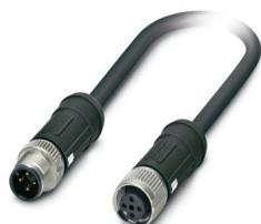
Cavo sensore/attuatore, 4-poli, PE-X senza alogenati, nero RAL 9005, schermata, Maschio diritto M12 SPEEDCON, codifica: A, su Connnettore femmina diritto M12 SPEEDCON, codifica: A, lunghezza cavo: 2 m, Per le applicazioni ferroviarie
