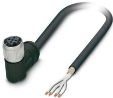
Cavo sensore/attuatore, 4-poli, PE-X senza alogenati, nero RAL 9005, schermata, estremità conduttore libera, su Connettore femmina angolato M12 SPEEDCON, codifica: A, lunghezza cavo: 5 m, Per le applicazioni ferroviarie
