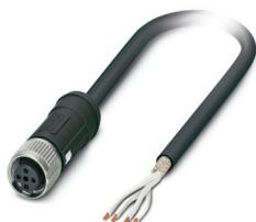
Cavo sensore/attuatore, 4-poli, PE-X senza alogenati, nero RAL 9005, schermata, estremità conduttore libera, su Connettore femmina diritto M12 SPEEDCON, codifica: A, lunghezza cavo: 5 m, Per le applicazioni ferroviarie
