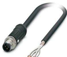
Cavo sensore/attuatore, 4-poli, PE-X senza alogenati, nero RAL 9005, schermata, Maschio diritto M12 SPEEDCON, codifica: A, su estremità conduttore libera, lunghezza cavo: 5 m, Per le applicazioni ferroviarie
