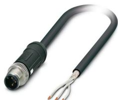
Cavo sensore/attuatore, 3-poli, PE-X senza alogenati, nero, schermata, Maschio diritto M12 SPEEDCON, codifica: A, su estremità conduttore libera, lunghezza cavo: 10 m, Per le applicazioni ferroviarie
