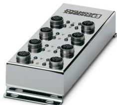
Scatola di distribuzione, tipo di connessione: Connettore femmina M12 Acciaio inossidabile, numero degli slot: 8, numero poli: 5, codifica: A, occupazione slot: parallelo, segnalazione di stato: no, Universale, schermatura: sì
