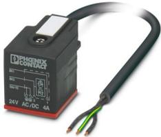
Cavo sensore/attuatore, 3-poli, PUR senza alogenati, nero RAL 9005, estremità conduttore libera, su Connettore per valvole A, con 1 LED , Circuito: Diodo Z, lunghezza cavo: 10 m, per applicazioni outdoor , con vite centrale in acciaio inox e guarnizione supplementare in silicone (rossa)
