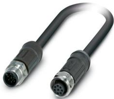
Cavo sensore/attuatore, 8-poli, PE-X/PE-X senza alogenati, grigio-nero RAL 7021, schermata, Maschio diritto M12, codifica: A, su Connettore femmina diritto M12, codifica: A, lunghezza cavo: 2 m, per applicazioni outdoor, con zigrinatura in acciaio inox
