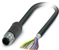
Cavo sensore/attuatore, 8-poli, PE-X/PE-X senza alogenati, grigio-nero RAL 7021, schermata, Maschio diritto M12, codifica: A, su estremità conduttore libera, lunghezza cavo: 2 m, per applicazioni outdoor, con zigrinatura in acciaio inox
