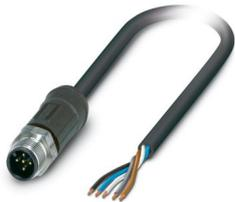
Cavo sensore/attuatore, 5-poli, PE-X senza alogenati, grigio-nero RAL 7021, Maschio diretto M12, codifica: A, su estremità conduttore libera, lunghezza cavo: 2 m, per applicazioni outdoor, con zigrinatura in acciaio inox
