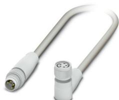
Cavo sensore/attuatore, 4-poli, PP-EPDM senza alogenati, grigio RAL 7035, Maschio diritto M8, codifica: A, con 2 LED, su Connettore femmina angolato M8, codifica: A, con 2 LED, lunghezza cavo: 0,3 m, Hygienic Design, con ghiera in plastica
