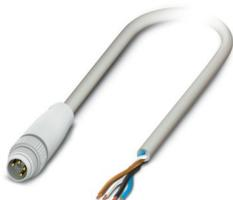
Cavo sensore/attuatore, 4-poli, PP-EPDM senza alogenati, grigio RAL 7035, Maschio diritto M8, codifica: A, su estremità conduttore libera, lunghezza cavo: 5 m, Hygienic Design, con ghiera in plastica
