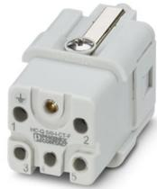
Inserto contatti, numero poli: 5+PE, dimensioni: D7, numero di connessioni per polo: 1, Femmina, Connessione a crimpare, 230 V/400 V, 20 A, 0,5 mm<sup>2</sup> ... 2,5 mm<sup>2</sup>, applicazione: Potenza
