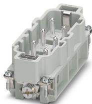
Inserto contatti, numero poli: 6+PE, dimensioni: B16, Spina, Connessione a vite, 400 V/690 V, 41 A, 0,5 mm<sup>2</sup> ... 6 mm<sup>2</sup>, applicazione: Potenza
