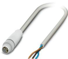
Cavo sensore/attuatore, 3-poli, PP-EPDM senza alogenati, grigio RAL 7035, Maschio diritto M8, codifica: A, su estremità conduttore libera, lunghezza cavo: 1,5 m, Hygienic Design, con ghiera in plastica
