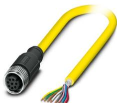
Cavo sensore/attuatore, 8-poli, PVC, giallo, schermata, estremità conduttore libera, su Connettore femmina diritto M12, codifica: A, lunghezza cavo: 5 m
