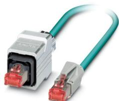
Cavo Ethernet confezionato, CAT5e, schermato, 2 coppie, AWG 26 flessibile (7 fili), RAL 5021 (azzurro mare), connettore maschio RJ45/IP67, Push-Pull, custodia in metallo, su connettore maschio RJ45/IP20, Line, lunghezza 5 m
