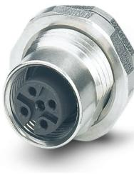
Connettore per apparecchi posteriore, 4-poli, Femmina, diritto, M12, codifica: A, Montaggio posteriore, Pg9, Saldatura a onde, Questo articolo è in continuo adattamento. Alternativa senza piombo secondo RoHS II senza eccezione 6c (Pb < 0,1%) possibile in anticipo su richiesta.
