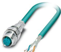
Connettore per apparecchi anteriore, Ethernet CAT5 (100 MBit/s), Ethernet, 4-poli, PUR, azzurro mare RAL 5021, schermata, Femmina, diritto, M12-SPEEDCON, codifica: D, su estremità conduttore libera, Montaggio anteriore, M16 x 1,5, Linea bus, lunghezza cavo: 5 m, Ethernet flessibile CAT5, a 2 coppie, Questo articolo è in continuo adattamento. Alternativa senza piombo secondo RoHS II senza eccezione 6c (Pb < 0,1%) possibile in anticipo su richiesta.
