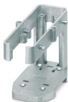
Telai di montaggio per guide DIN HEAVYCON, base per bloccaggio trasversale, per custodia con bloccaggio trasversale oppure parte superiore HC-CIF-..HFFD.., per due inserti portacontatti di tipo B6, per guide di supporto NS35/7,5
